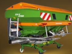
ZA-V: Behältervolumen 1.400 l bis 4.200 l Arbeitsbreite 10 m bis 36 m
