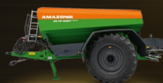
ZG-TS: Behältervolumen 7.500 l bis 10.000 l Arbeitsbreite 15 m bis 54 m
