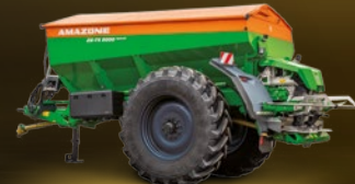
ZG-TX: Behältervolumen 6.800 l bis 11.200 l Arbeitsbreite 15 m bis 54 m
